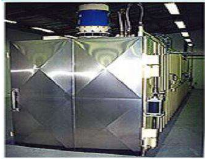
Hình 3.17. Máy (phòng) hấp tiệt trùng (dùng ở quy mô công nghiệp)
