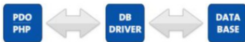
Hình 11.5: Mô hình dùng PDO kết nối đến CSDL từ PHP
