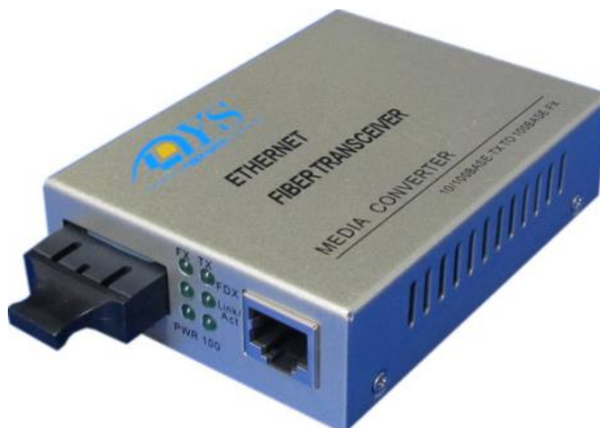
Hình 4.9 Kiểm tra đèn trên bộ Media Converter
