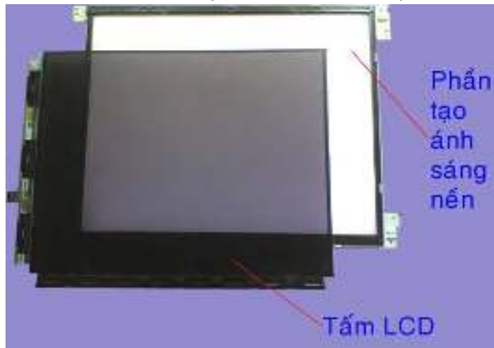
Hình 1.4.10: Đèn hình gồm tấm LCD và phần tạo ánh sáng nền
