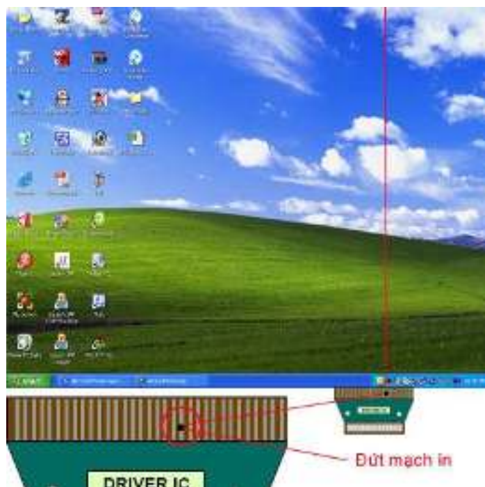
Hình 1.4.3: Nguyên nhân của đường kẻ dọc không đổi màu sắc là do đứt mạch ở sau IC Drive hoặc đứt trên màn hình
