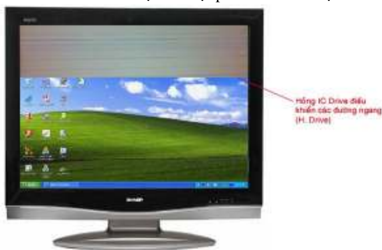
Hình 1.4.6: Màn hình bị mất một phần hình ảnh ngang màn hình
