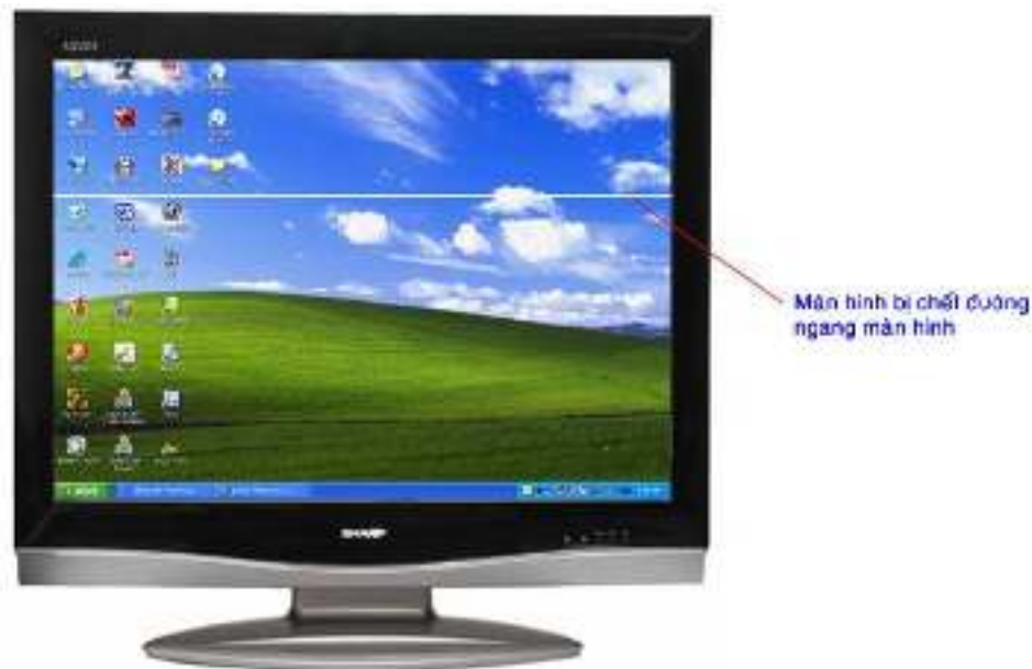
Hình 1.4.2: Hiện tượng chết đường kẻ ngang màn hình
