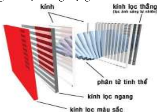
Hình 1.3.3: Cấu tạo các lớp màn hình LCD
