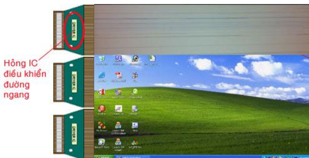
Hình 1.4.8: Hồng IC điều khiển đường ngang sẽ dẫn đến mất một phần hình ảnh ngang màn hình
