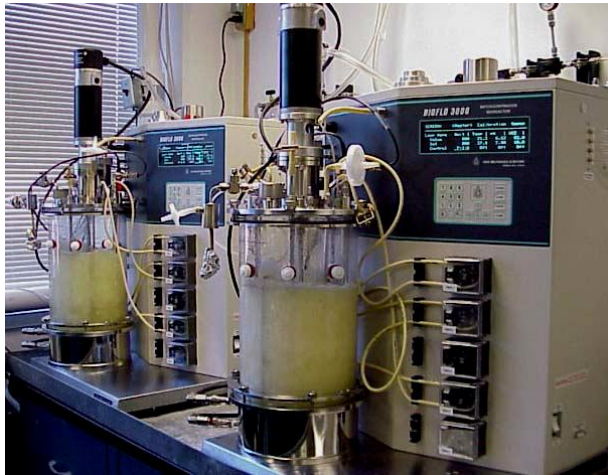
Hình 3.8. Lên men bằng phương pháp nuôi cấy chìm trong môi trường lỏng ở quy mô phòng thí nghiệm (5 L)
